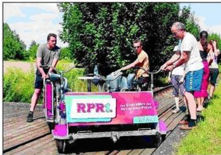
Rangieren per Hand: Bei Bedarf lässt sich die Draisine an den „Bahnhöfen“ recht mühelos aus dem Gleis heben und parken. FOTO: SANA
